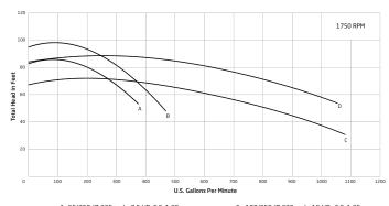
A. 65/250 (Ø 225mm) - 7.5 HP S.F. 1.25 B. 65/250 (Ø 240mm) - 10 HP S.F. 1.25 C. 100/250 (Ø 220mm) - 15 HP S.F. 1.25 D. 100/250 (Ø 240mm) - 20 HP S.F. 1.00
